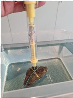
Jetzt wird der Stein an der Federwaage ins Wasser getaucht. Die Kinder beobachten, wie sich das Gewicht des Steins scheinbar verändert. Sie sehen, die Stärke der Auftriebskraft.
