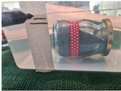
Es versinkt und verdrängt damit mehr Wasser als das leere Glas. Der Wasserstand wird wieder markiert.
