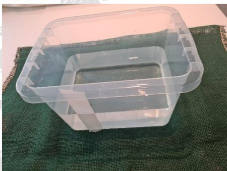
Das große Gefäß wird zur Hälfte mit Wasser gefüllt. An eine Seite wird ein Streifen Maler-Kreppband geklebt.
