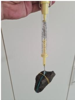
In die Gummiringe kann man nun die Federwaage einhängen. Die Hand wird ruhig gehalten, sodass man das Gewicht ablesen kann.
